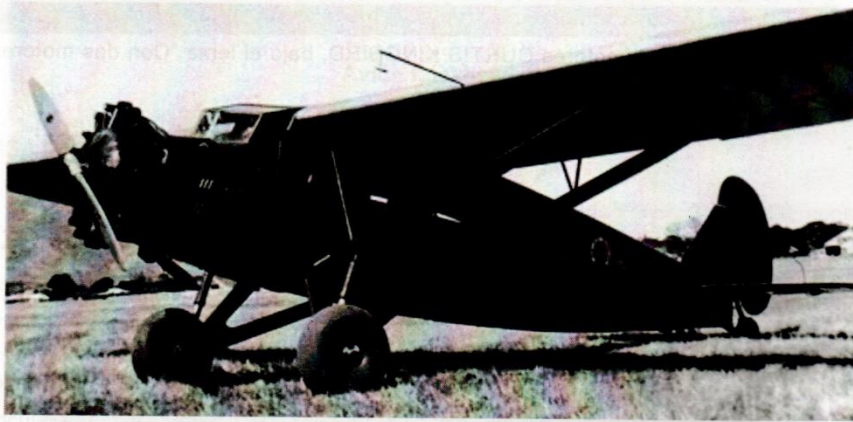
Avion TRAVELAIR 6000 - Monomotor para piloto y 5 pasajeros
