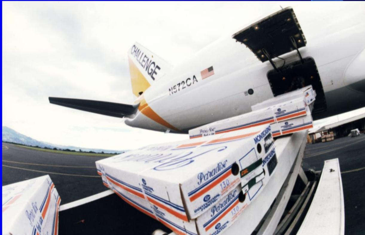
**Los nuevos sistemas de manejo de carga paletizada en los aviones jet agilizaron enormemente la carga y descarga de las aeronaves, disminuyendo el deterioro de los productos al ser abordados.**
